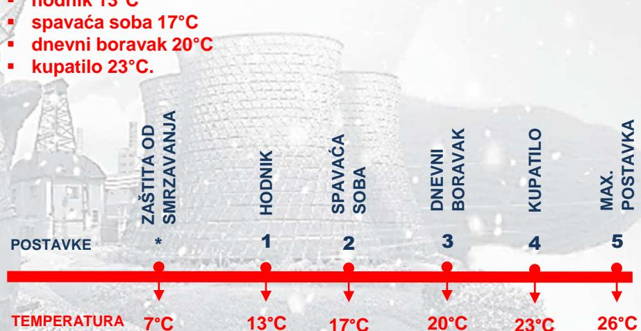
Radijatorski termostat održava konstantnu temperaturu u vašoj prostoriji. Postavite vrijednosti u skladu sa preporučenim vrijednostima temperature koji su ovdje navedeni.
